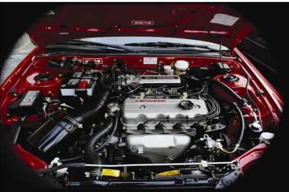
相對於筆直配管輸送流體的硬質鐵管 (pipe)，橡膠管(rubber hose)具有硬鐵管所無法擁有之柔軟彈性、可撓可彎曲性及耐壓性、防振吸振之特性，適用於活動性處之輸送能量配管，特別是空間狹窄、振動之作業環境。譬如射出成型機、挖土機、推高機之類，輸送高壓力能量的油壓管(hydraulic hose)；或汽車引擎室之各種輸送燃料油、瓦斯氣、冷卻水、空氣的橡膠管，同時兼具輸送能量及吸收防止振動效果；或空壓設備、氣焊設備、燃燒器設備所連接之活動式輸送管路。因此橡膠管的管狀傳導輸送性、柔軟可撓性活動性、耐壓性、吸振性，就如同人體的血管命脈一般重要，發展出不同的尺寸及用途，在機械設備業、交通汽車
